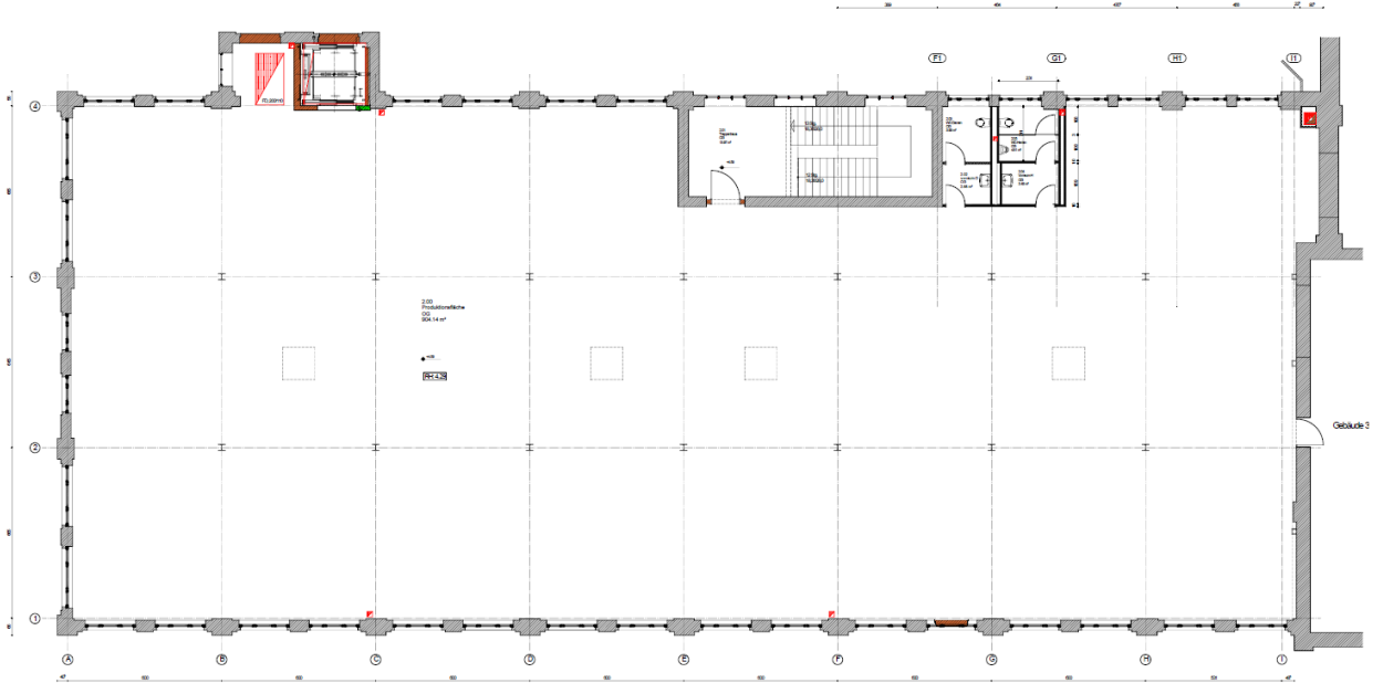
Obergeschoss ohne Leichtbau-Trennwände
